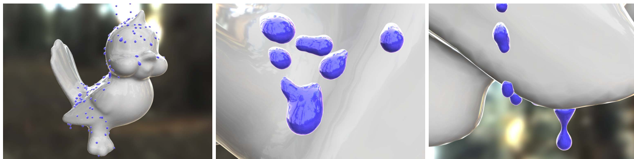
图 2.19 水滴落在小鸟模型上的效果 该场景中水滴包含约1万个三角形，仿真速度为10FPS。
