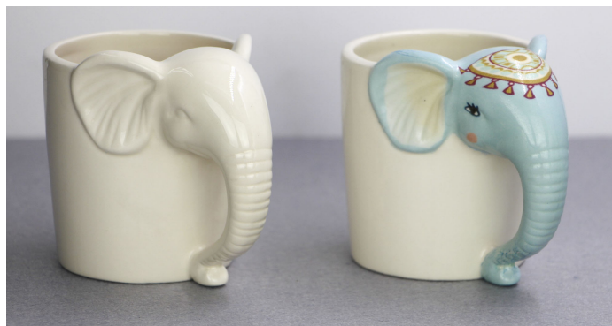
图 3.16 大象杯-陶瓷表面的水转印实验 白色的陶瓷大象杯为直接购买的成品，因此先通过3D扫描获取其几何形状，由艺术家在数字化模型上设计纹理，最终通过水转印系统为其着色。
