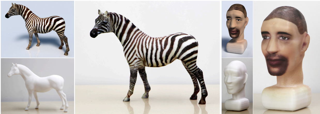
图 3.18 两次转印实验 每个结果大图为着色之后的模型，左上小图为数字化模型的渲染图，左下小图为未着色的3D模型。
