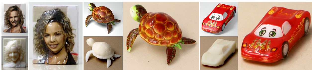
图 4.15 通过真空热塑成型制做的彩色模型 每个结果大图为着色之后的模型，左上小图为数字化模型的渲染图，左下小图为未着色的3D模型。
