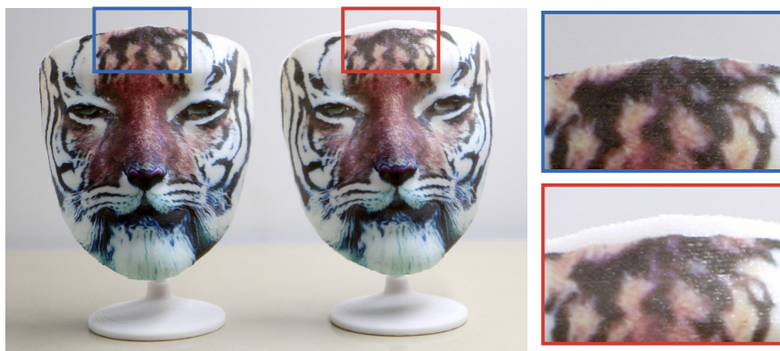
图 3.9 颜料对薄膜拉伸程度的影响 水转印物理过程中，颜料的厚度会对PVA膜拉伸性产生影响：颜料越厚就越难拉伸，因此如果在仿真计算时就考虑颜料厚度，就可以提高计算的精度。左侧模型是仿真时考虑了颜料厚度的着色结果，模型与图案精确对齐。右侧模型是将PVA膜当成均一厚度仿真的着色结果，图案计算偏小，因而没有完全与模型对齐。
