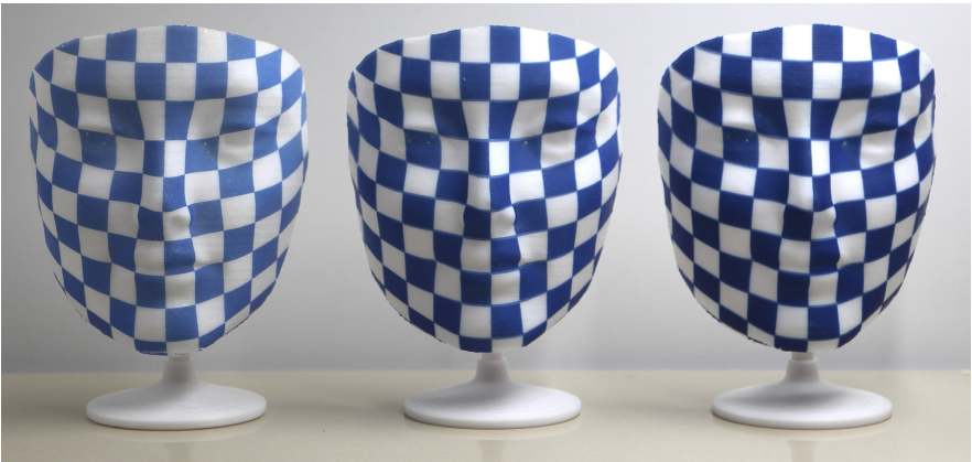
图 3.13 水转印可重复性验证 用相同的棋盘格图案，完全相同的转印过程，对面具模型进行着色。从左到右，模型分别转印了一次、两次、三次。每次转印图案都能够对齐，因此看起来颜色在逐渐加深，从而证明水转印过程是可重复的。
