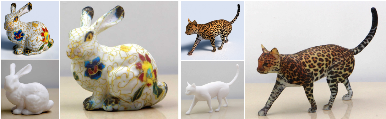
图 3.19 三次转印实验 每个结果大图为着色之后的模型，左上小图为数字化模型的渲染图，左下小图为未着色的3D模型。
