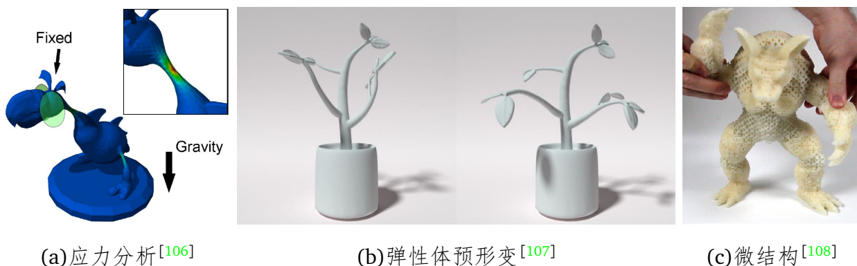
图 1.14 弹性体应力分析在3D打印中的应用案例 (a)将模型当成弹性体进行应力分析，找出结构上薄弱之处，并通过加粗、中空减重、增加支撑等方法进行改进，使最终打印的模型具有较高的强度。(b)对弹性体进行预形变，使打印的软体模型在重力作用下形变之后，与设计模型形状一致。(c)通过微结构实现宏观上不同的弹性强度，使得单一材料打印的模型宏观上成为不均匀弹性的物体。
