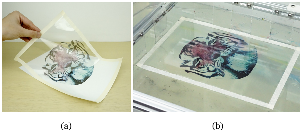
图 3.1 打印了图案的聚乙烯醇（PVA）膜 (a) 出厂时的PVA膜贴在一张光面A4纸上，因此使用普通喷墨打印机就可以在上面打印图案。(b) PVA膜从光面纸上揭下，四周用胶带固定并放置在水面，被活化之后就可以对物体转印图案了。
