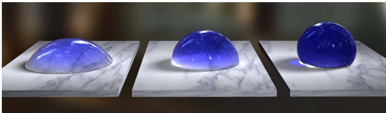
图 2.5 不同亲水性表面上水滴的稳定形状 通过设置不同的稳定接触角，可以模拟水滴在不同亲水性表面上的静止时的形状，图中的水滴从左到右稳定接触角依次为 60^\circ ， 90^\circ ， 120^\circ 。
