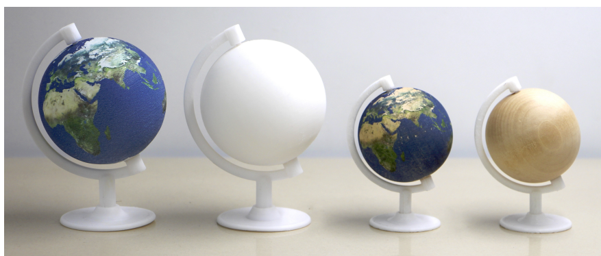
图 3.17 地球仪-塑料及木材表面的水转印实验 水转印膜能够拉伸并包裹整个圆球，因此地球仪的制作只需单次着色。图中左二为通过3D打印制作的塑料球，左四为木球，旁边为着色后的效果。
