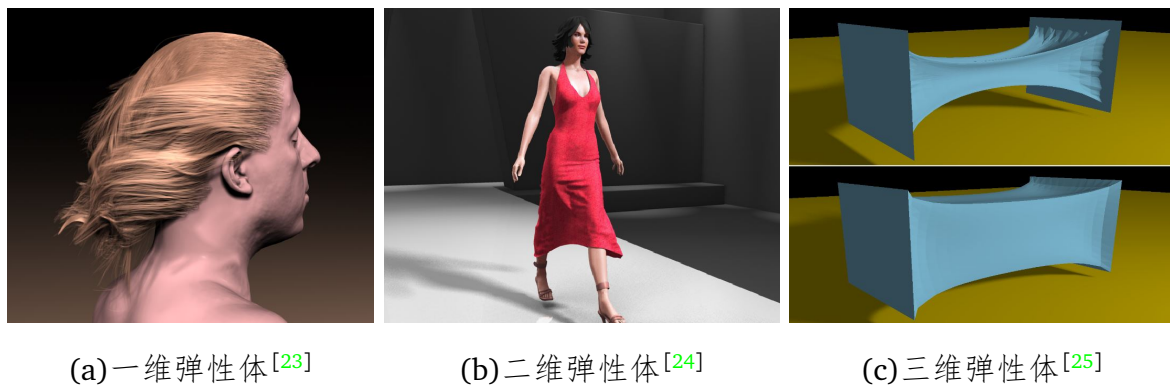
图 1.6 弹性体仿真 对一维、二维、三维弹性体采用对应拓扑维度的网格进行仿真。其中，二维弹性体（如布料）使用面网格来建模。
